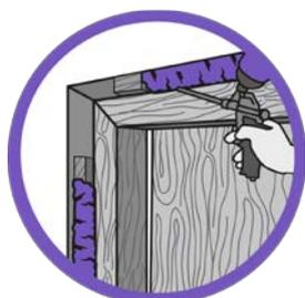
OLIVÉ PU-46 MULTIUSO pistola utiliza-se para instalar marcos de portas e janelas, enchimento de espaços vazios e gretas, isolamento de tubagens e cablagens.
