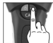
**METAL-SCAN:** Обнаружение металла во всех неметаллических материалах с индикацией глубины до 10 см (немагнитные металлы) и до 12 см (магнитные металлы).
