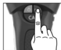
**AC-SCAN:** Localização de fios sob tensão até 2 cm diretamente por baixo de revestimentos não metálicos.
