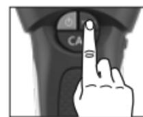
**AC-SCAN:** Lokalizacja przewodów znajdujących się pod napięciem położonych do 2 cm bezpośrednio pod niemetalicznymi zabudowami.
