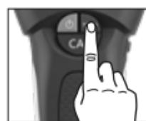
**AC-SCAN:** Lokalisering av spenningsførende ledninger opptil 2 cm rett under ikke-metalliske forskalinger.
