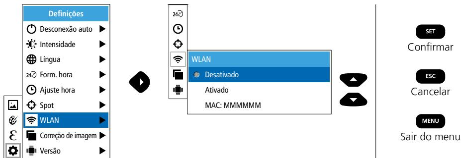
A seguir, no terminal é estabelecida a ligação com o SSID correspondente. Através de um navegador moderno à escolha, a ThermoCamera Connect disponibiliza os dados no endereço IP 192.168.230.1 Porta 80.
