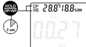
Die Einheiten °C/°F können durch langes Drücken der Taste „UNIT“ eingestellt werden.
